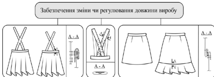
Рис. 3. Схеми трансформації основних видів асортименту форменого одягу для дівчат, що забезпечують зміну чи регулювання довжини виробу або його деталей
