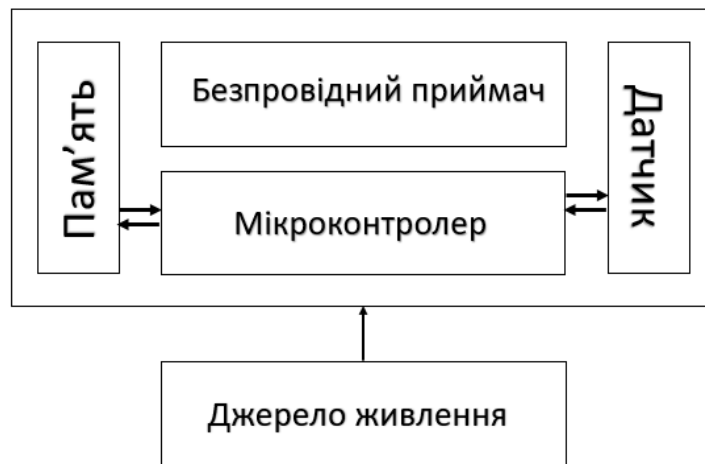
Рис. 4. Структурна схема моніторингової системи виміру концентрації пилу
