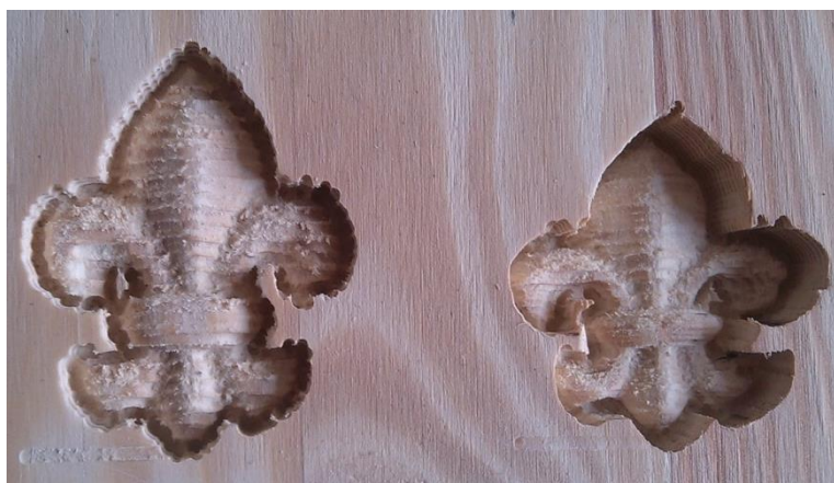
Рисунок 3 – Приклад роботи станка з ЧПК за заданою програмою для об'єктів з різними кроками проходу фрези
