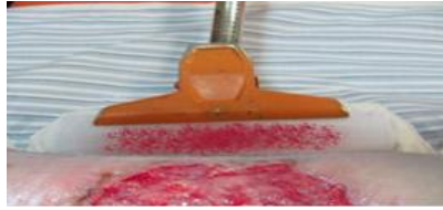
Рис. 1. Визначення зусилля відшарування за допомогою ручного динамометру
