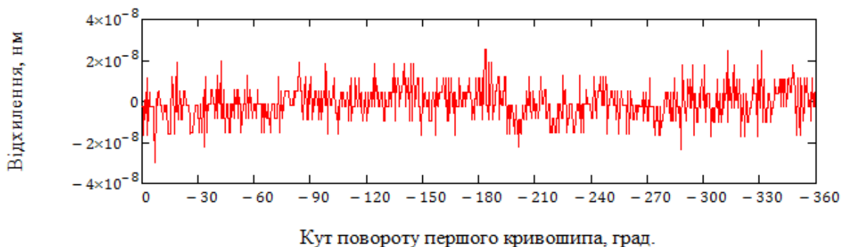
Рис. 4. Графік відхилення траєкторії повзуна від прямолінійної напрямної (крок розрахунку відхилення \Delta\varphi_1=0,5^\circ )
