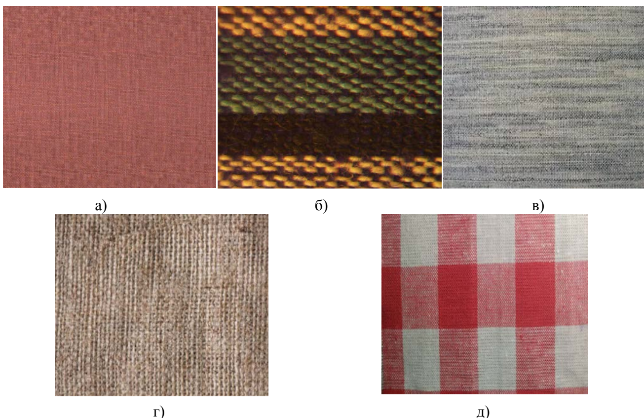
Рис. 2. Тканини, одержані з використанням волокон і ниток різного кольору: а) метод проектування однокольорових ефектів; б) метод проектування різнокольорових ефектів; в) метод меланжування; г) метод муліне; д) метод проектування пістрявих тканин
