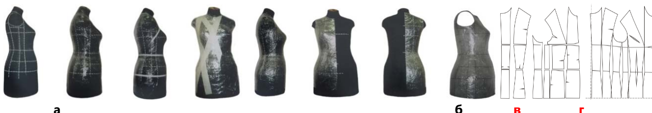
Рис. 4. Етапи робіт по отриманню технологічної жорсткої розгортки поверхні фігури людини за методом «Кокону»: а – етапи отримання «кокону» на манекені; б – знятий «кокон» з манекену; в – розгортка умовно технологічна; г – розгортка технологічна
