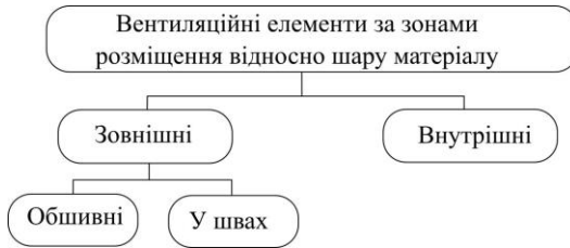
Рис. 26. Класифікація різновидів вентиляційних елементів за зоною розміщення щодо шарів пакету матеріалів у захисному одязі
