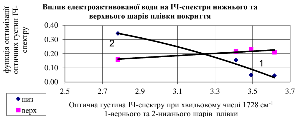
Рис.6. Вплив електроактивованої води на ІЧ-спектри верхніх та нижніх шарів плівки
