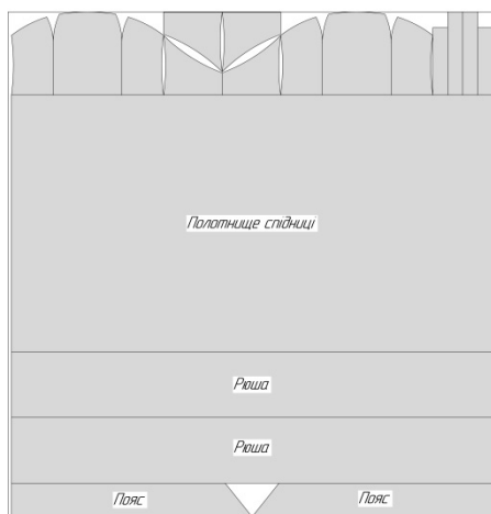
Рис. Розкладка лекал, виконана за безвідходним принципом
