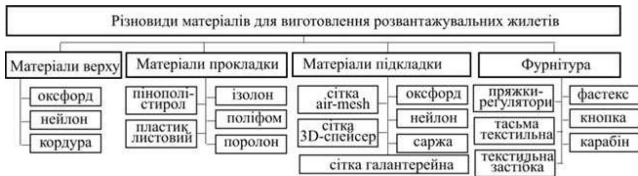
Рис. 1.15. Систематизація різновидів матеріалів для виготовлення розвантажувальних жилетів
