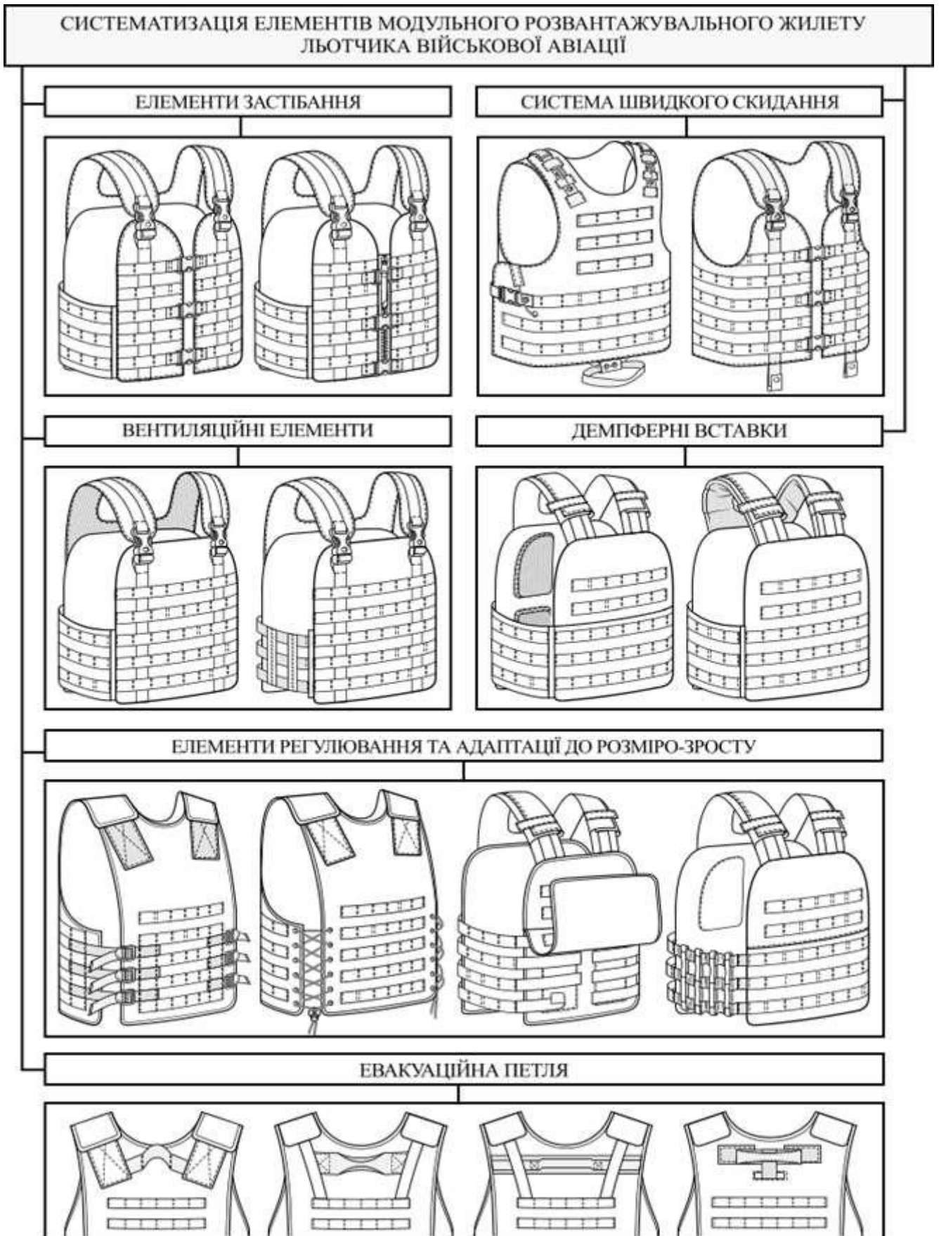
Рис. 4.4. Систематизація елементів модульного розвантажувального жилету для льотчика військової авіації
