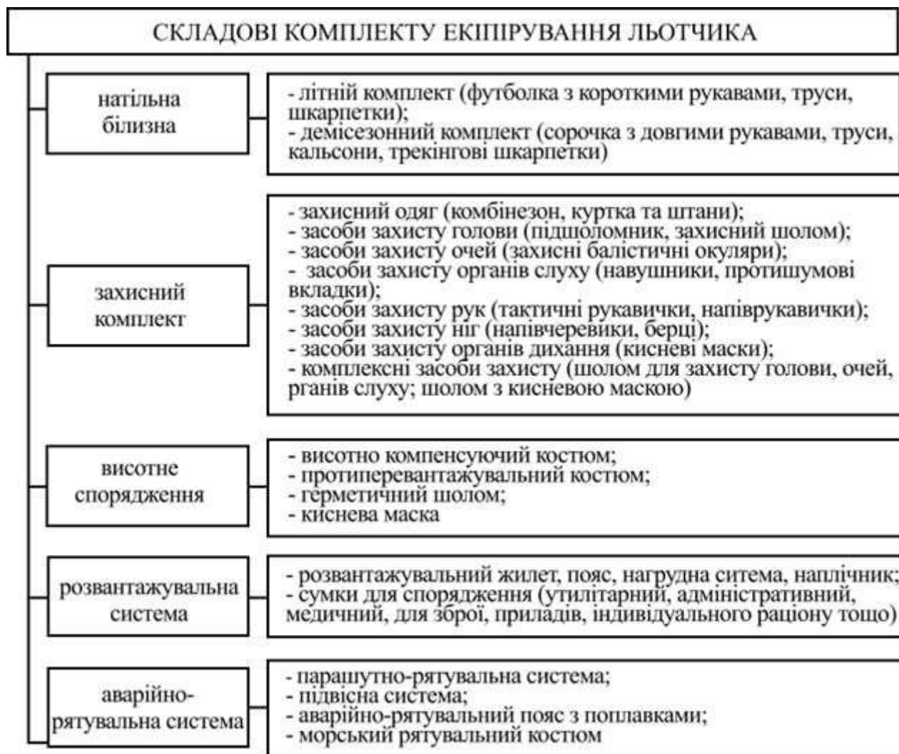
Рис. 1.5. Систематизація складових комплекту екіпірування льотчика військової авіації
