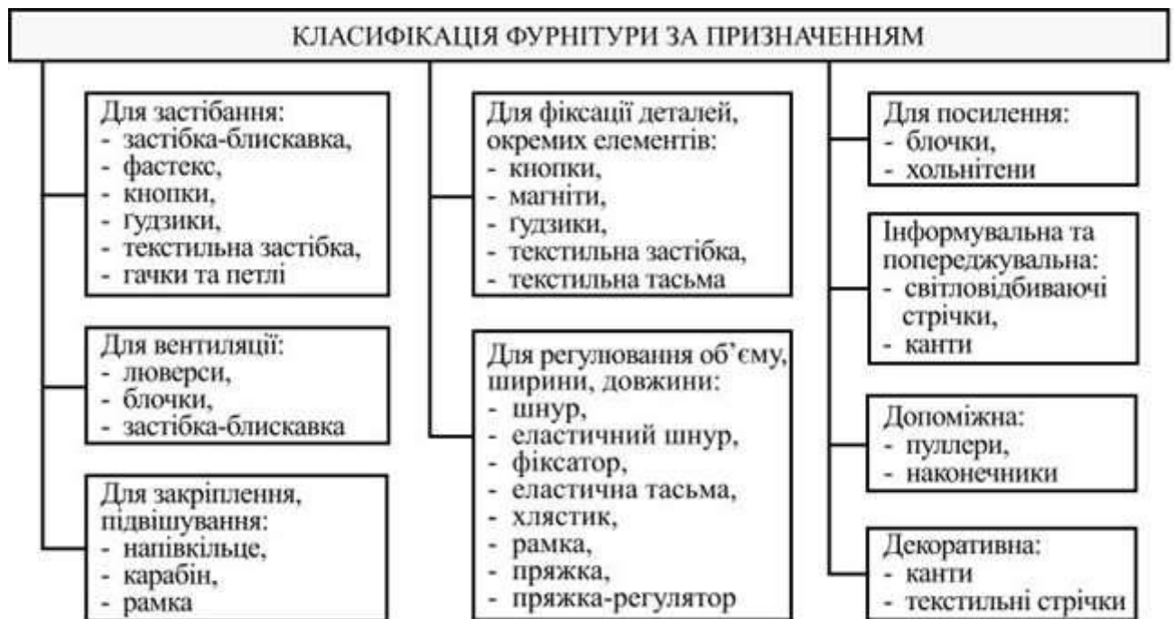
Рис. 4.24 – Систематизація різновидів швейної фурнітури для захисного одягу для льотчиків військової авіації за призначенням
