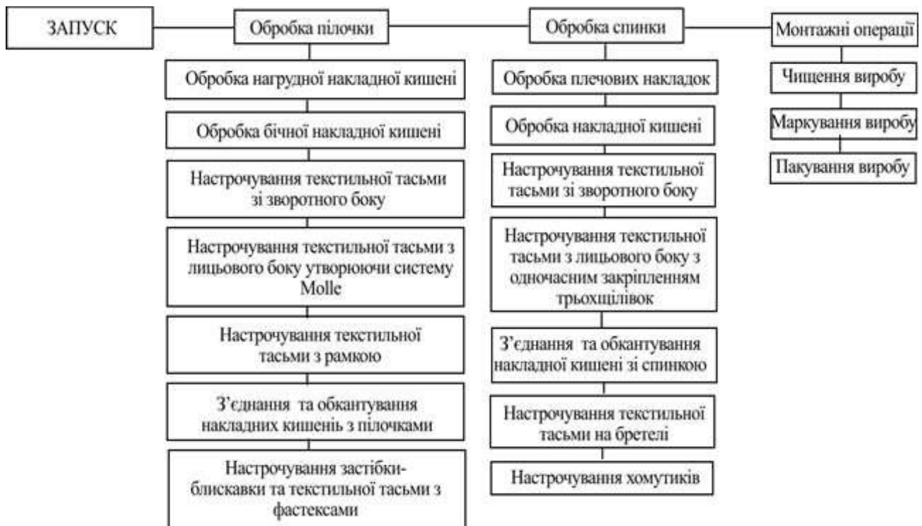
Рис.4.22 Технологічна послідовність виготовлення розвантажувального жилету
