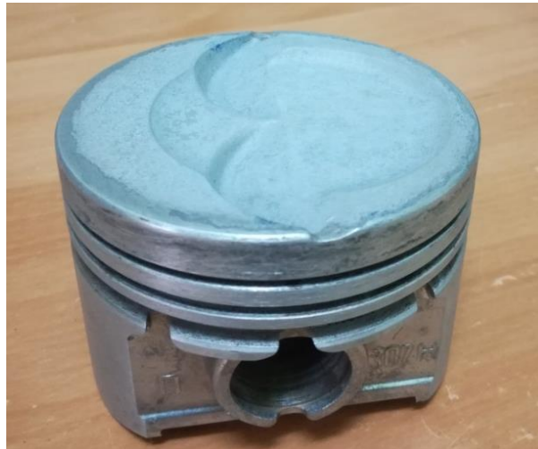
Рис. 8. Загальний вигляд поршня ДВЗ зі сформованим покривом Al|Al_2O_3 \cdot CoO_x
