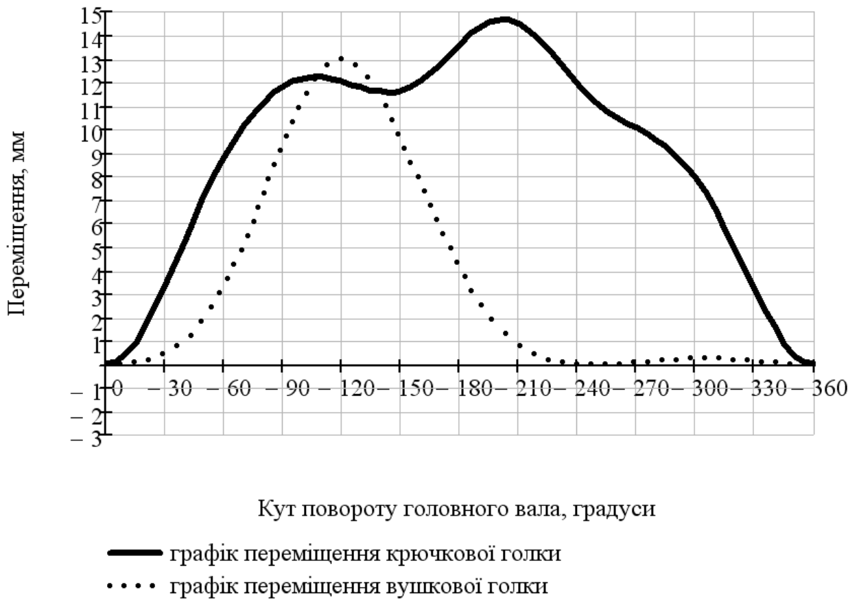
Рис. 6. Суміщені графіки переміщення крючкової голки та язичкової голки машини ОВ-7
