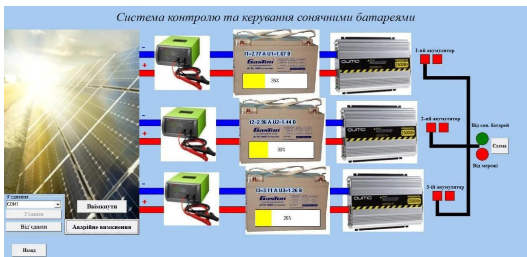
Рис. 3.26. При заряді акумулятора від 30% до 95%, джерелом живлення комп'ютерно-інтегрованої системи керування зовнішнім освітленням є електромережа
