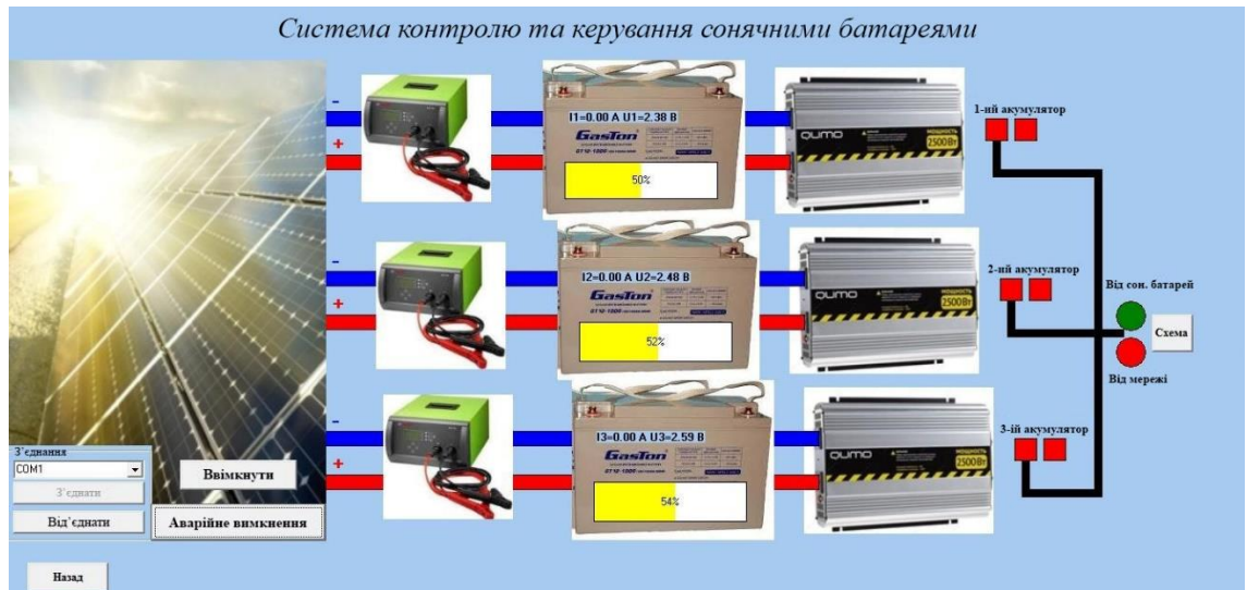
Рис. 3.28. Аварійне відключення при перегріві акумуляторів
