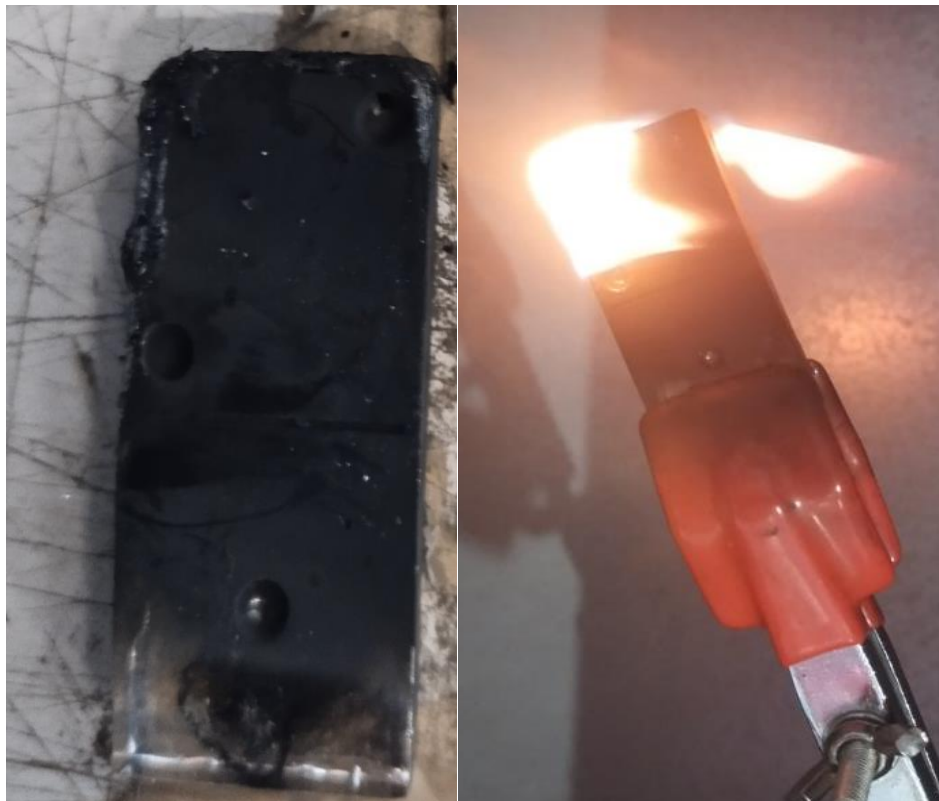
Рис.3.6. Епоксидна смола + вуглецеві волокна.
