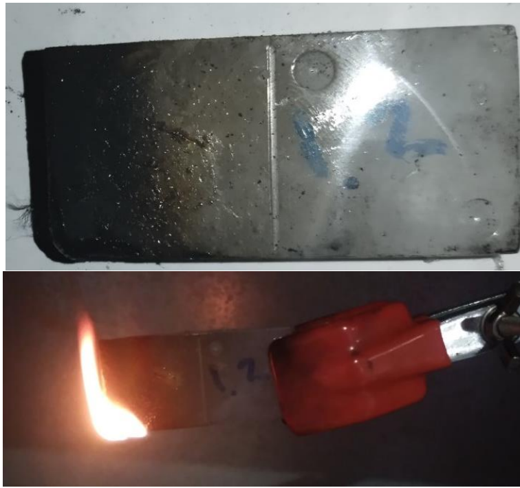
Рис.3.5. Епоксидна смола +поліпропіленова фібра.
