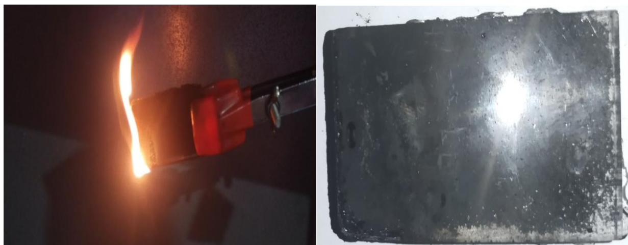
Рис.3.4. Епоксидна смола +LGB-13 (графіт).
