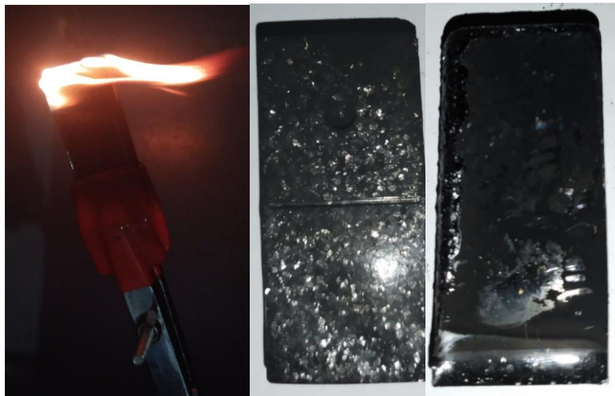
Рис.3.8. Епоксидна смола +лускатний графіт.
