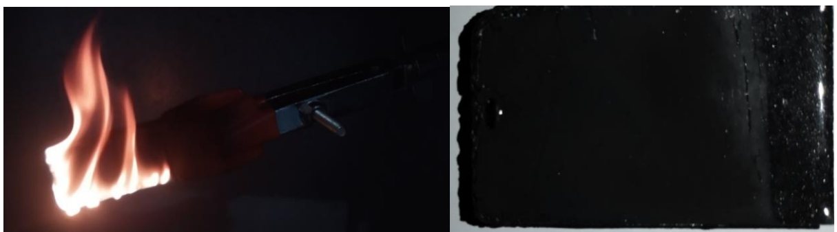
Рис.3.9. Епоксидна смола +графітова пудра.
