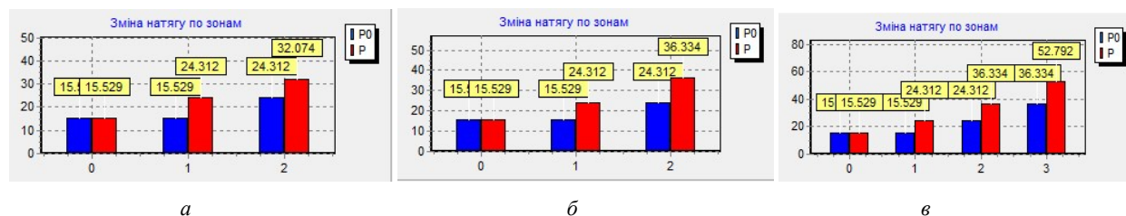
Рис. 4. Діаграми зміни натягу: а) з шайбовим пристроєм для натягу та компенсатором з кільцями; б) з двома шайбовими пристроями для натягу; в) з трьома шайбовими пристроями для натягу
