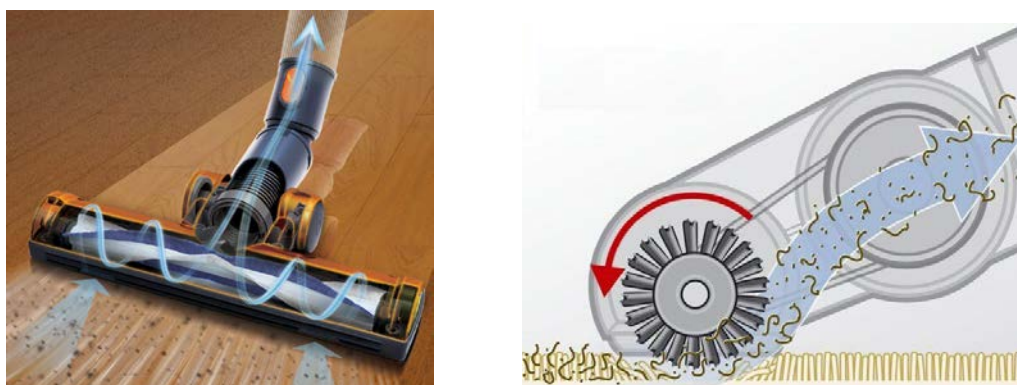
Рисунок 1 – Схема руху потоку повітря усередині турбощітки
