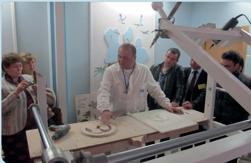
Мал. 4.3. Робота зі створення панно на фрезерно-копіювальному верстаті у навчально-практичному центрі Кнауф (Тернопіль)
