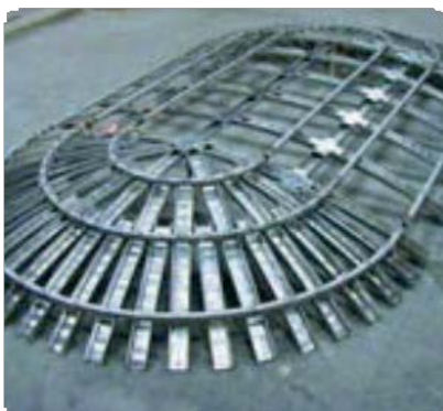
Мал. 6.41. Приклад плоского каркаса склепіння еліптичної форми
