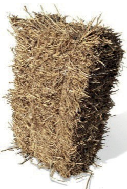
Мал. 8.16. Використання природних матеріалів у будівництві екологічного житла: А - солом'яний блок; Б - стіновий каркас із соломи; В - дах із очерету
