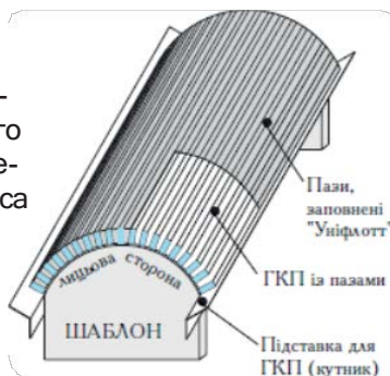
Мал. 6.21. П-подібні паралельні пази та фрагменти сформованих криволінійних гіпсокартонних елементів малого радіуса
