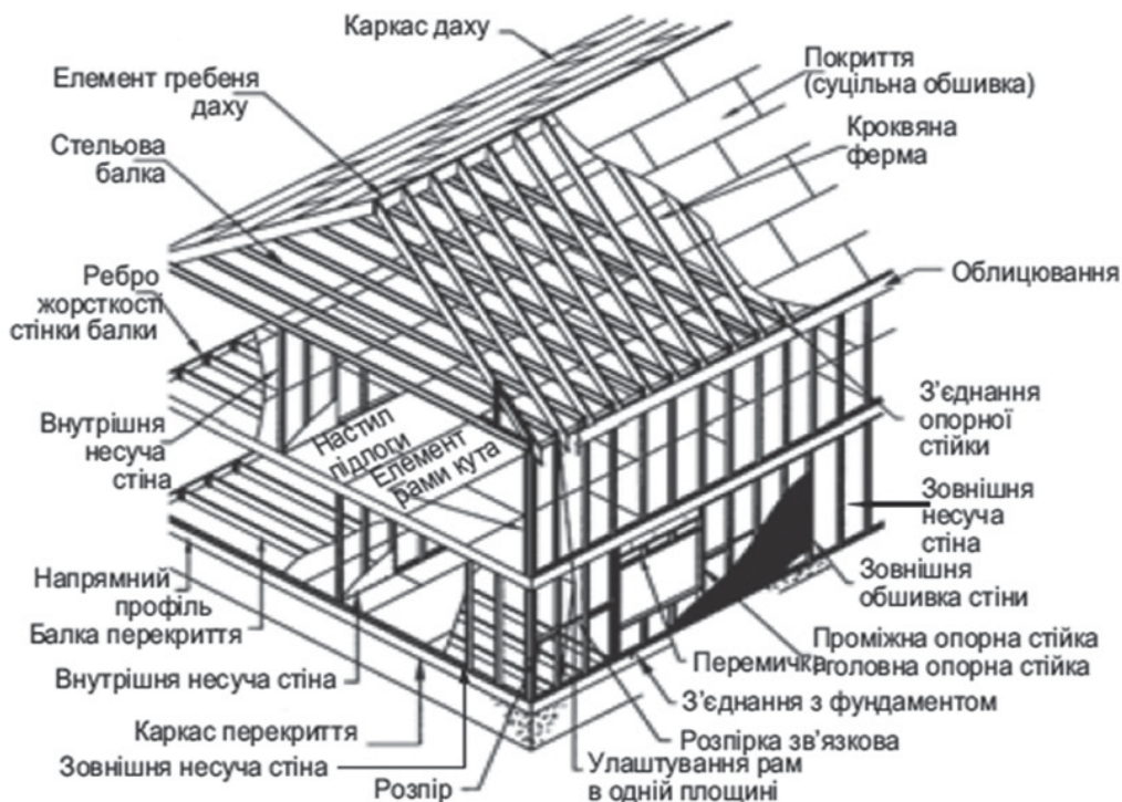
Мал. 3.28. Схематичне зображення каркаса двоповерхового будинку з металевих елементів
