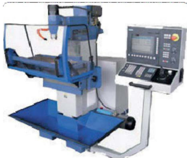
Мал. 1.14. Б. Сучасний фрезерний верстат із цифровим програмним керуванням
