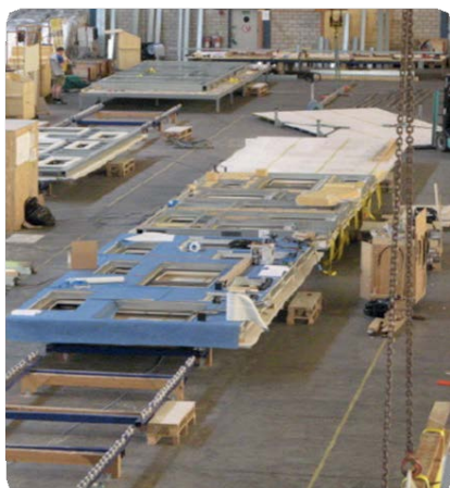
Мал. 3.46. Монтаж каркаса будинку з улаштуванням горищного приміщення методом поелементного збирання
