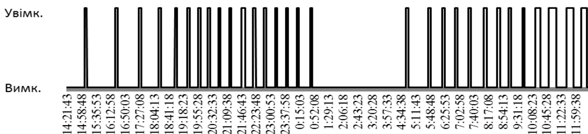
Рис 1. Кількість запусків та тривалість роботи вентилятора динамічного ТАЕП протягом приблизно 22 год
