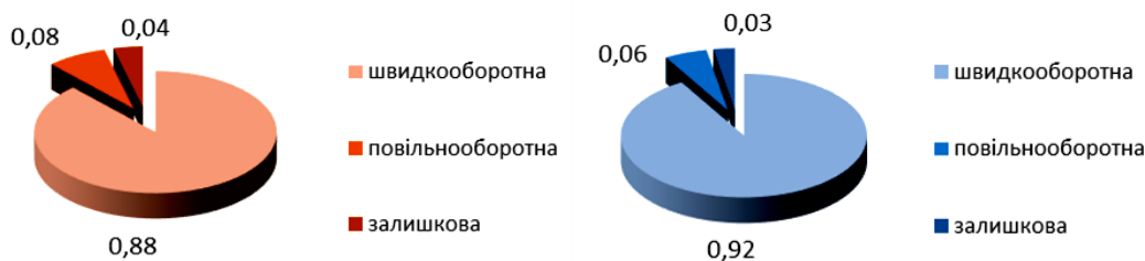
Рис. 9. Складові частки повної деформації при розтягуванні трикотажного полотна зразка 3 (а – по ширині; б – по довжині)
