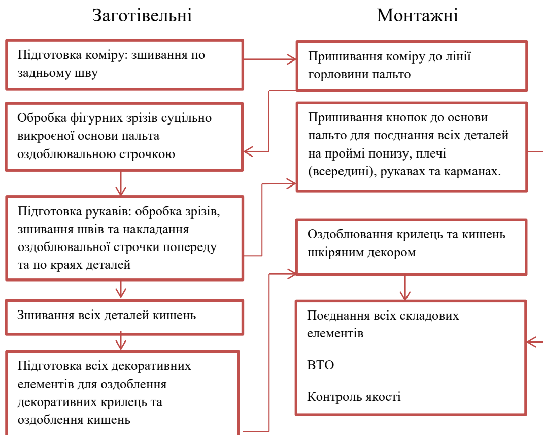
Рисунок 1.6 – Структурна схема виготовлення пальто жіночого легкого
