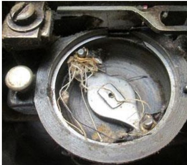
Рис. 1.2 Приклад неправильної заправки шпульки
