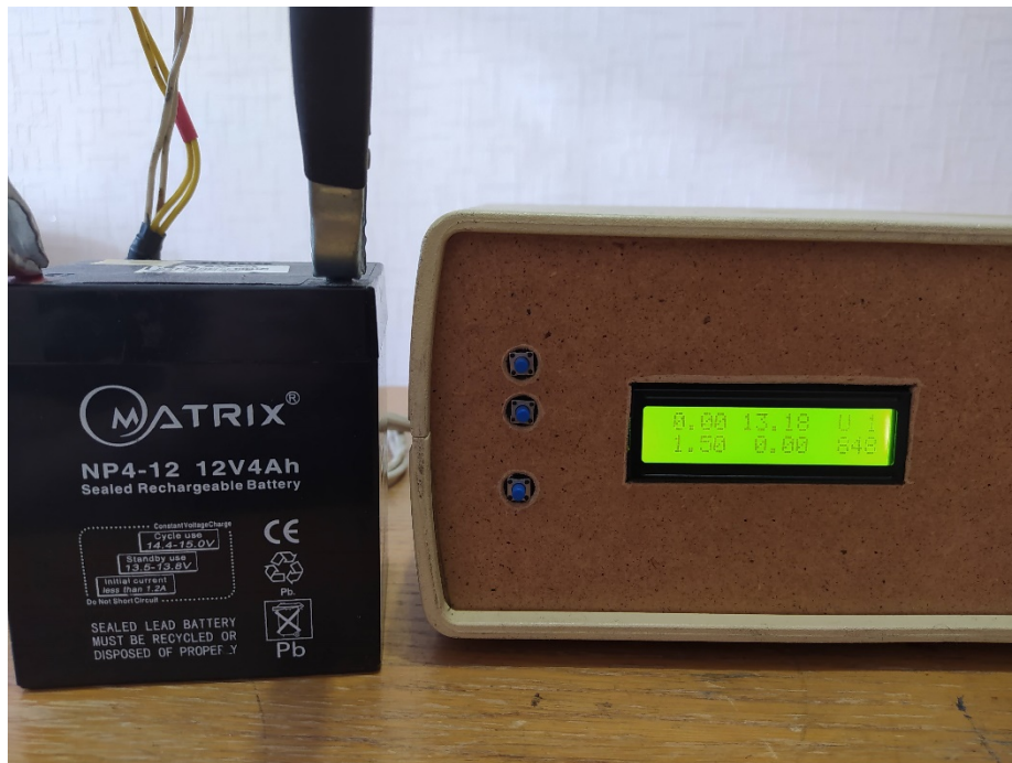
Рис3.24 Режим вимірювання напруги на акумуляторів
