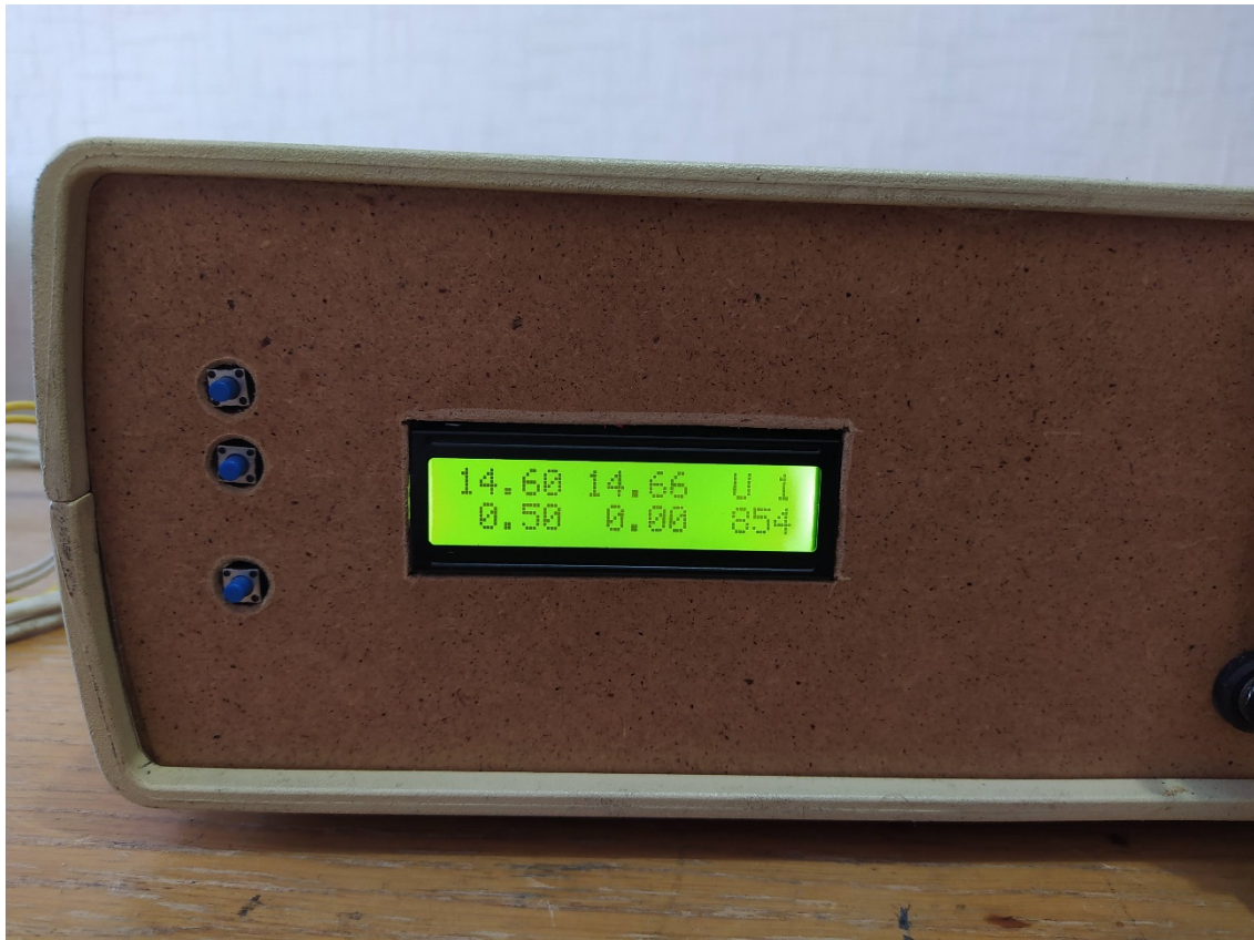
Рис3.22 Встановлення необхідної напруги
