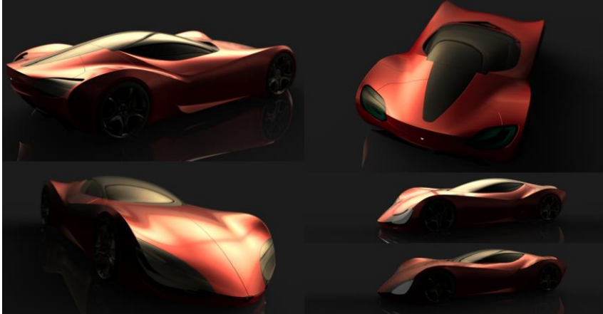
Рис.3. Об'ємна 3D модель спортивного автомобіля в CAD програмі Autodesk Alias
