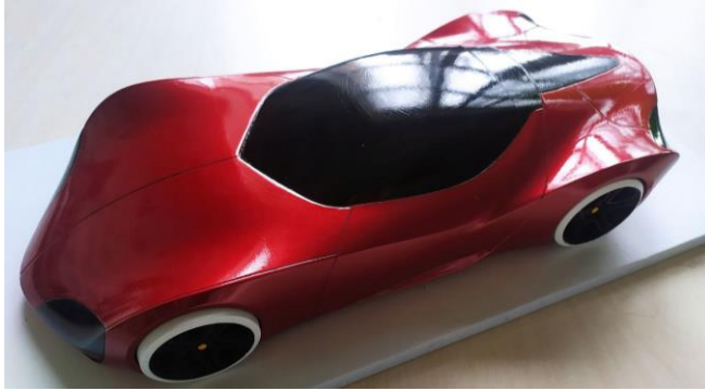
Рис. 5. Макет, роздрукований на 3D принтері за моделлю, створеною CAD програмою Autodesk Alias
