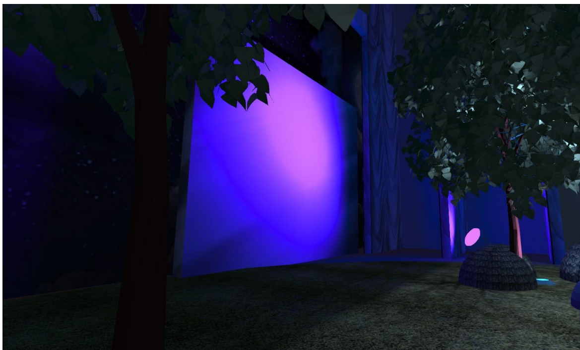
Рис. 3.3.2. 3D модель сцени театру імені М. Гоголя. Ефект відбиття за допомогою світлофільтру та дзеркала. Програма Dialux.evo
