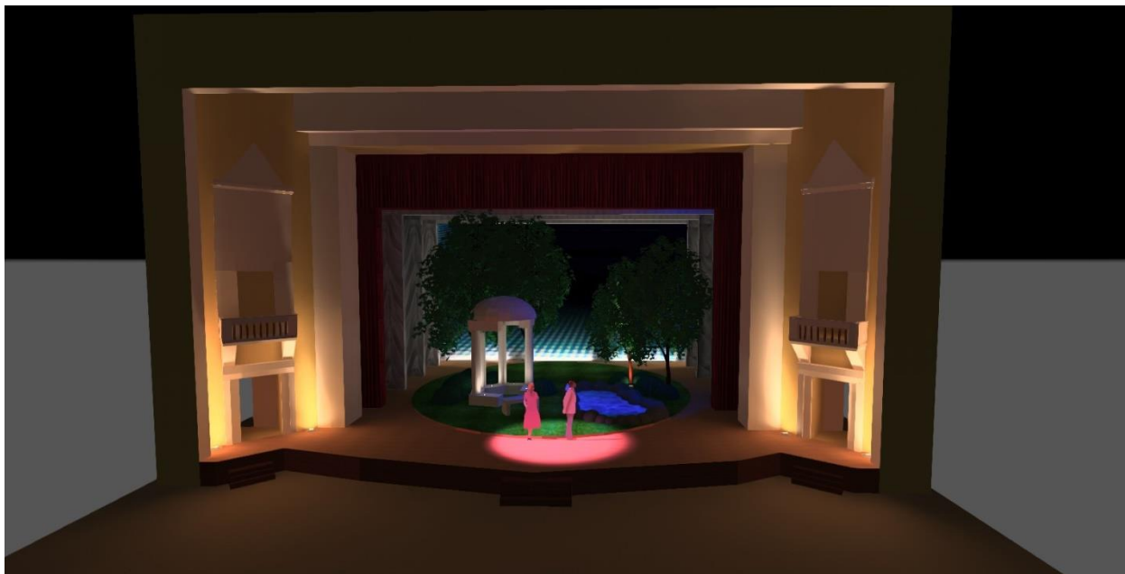
Рис. 3.3.3. 3D модель сцени театру імені М. Гоголя. (другий варіант). Специфічне освітлення. Програма Dialux.evo
