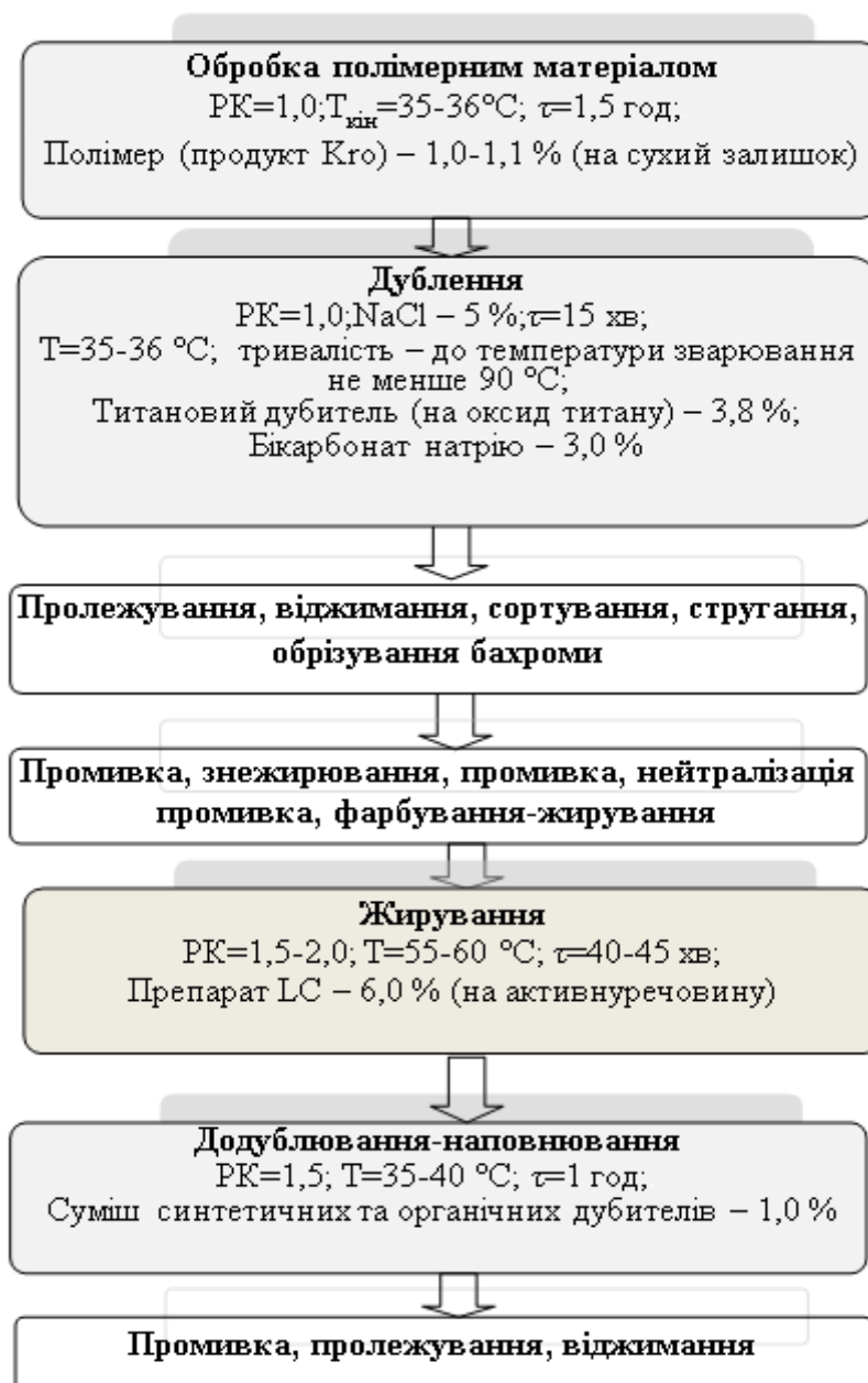
Рис. 4.6. Схема ресурсоощадної технології титанполімерного дублення шкір для одягу з овчини
