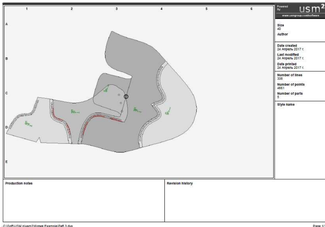
Рис. 3.20 – Приклад друку повної моделі деталей верху напівчеревика з настроєними берцями
