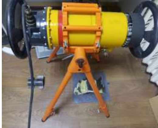
Рисунок 5 – Генератор рентгенівського випромінювання Baltospot GFD165
