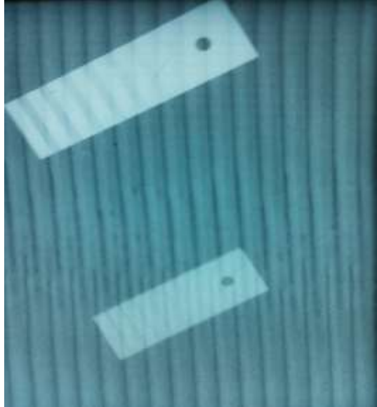
Рисунок 7 – Рентгенівський знімок зразка № 2 (поверхня зразка після 3D друку)
