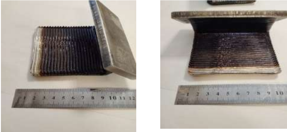
Рисунок 3 – Зразок №2 — Матеріал титан товщина 10 мм розмір 100x100x30 мм, поверхня після 3D друку
