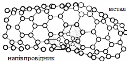
Рис. 2.7. Модель вигнутої вуглецевої трубки – діода
