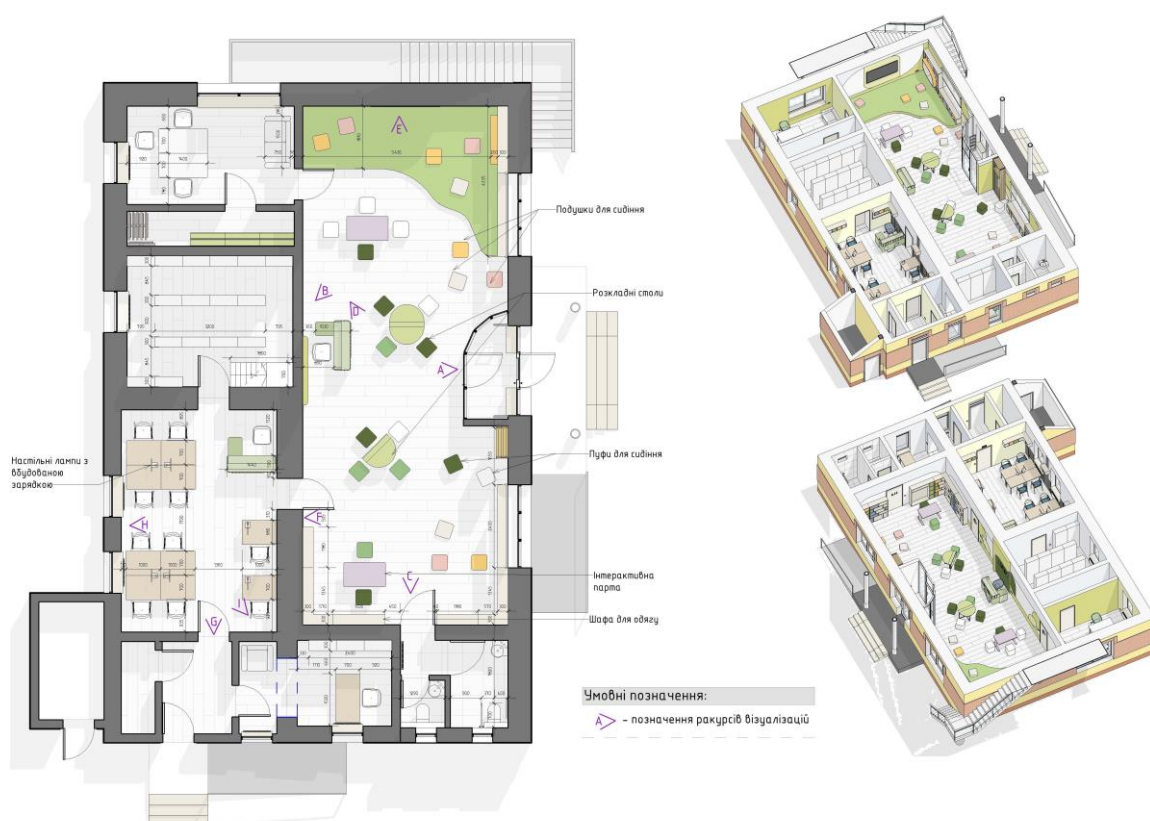
Рис. 3.4. План будівлі з розташуванням меблів першого поверху
