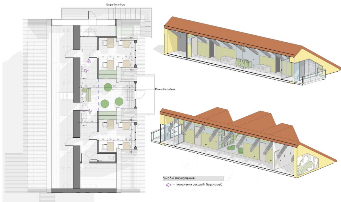
Рис. 3.5. План будівлі з розташуванням меблів другого поверху
