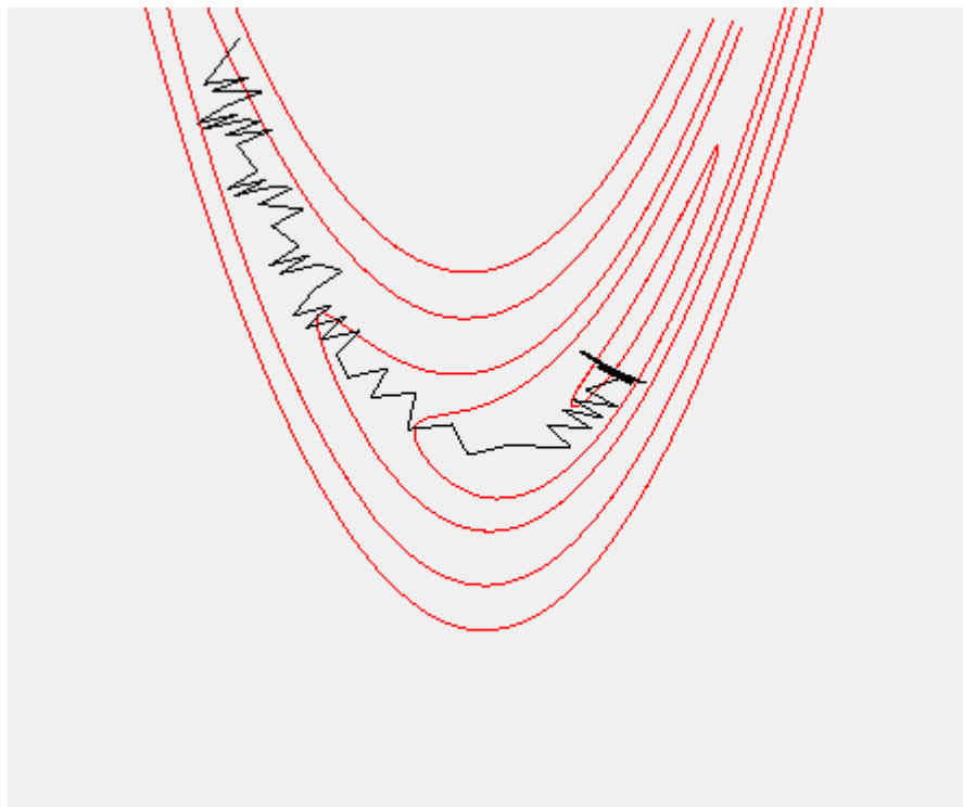
Рис 2.2.6 Траєкторії субградієнтних алгоритмів для функції Розенброка (алгоритм 2 з постійною відстанню між послідовними планами)
