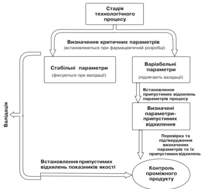
Рисунок 3.3 – Алгоритм валідації технологічного процесу виробництва стерильних лікарських засобів
