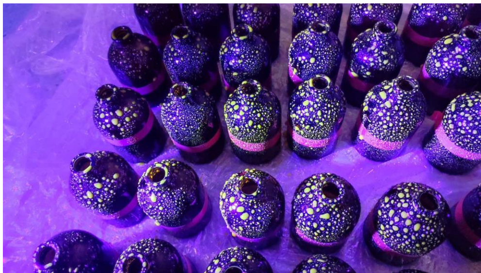
Рисунок 2.8 – Тестові флакони для досліджень відсутності хімічних речовин з рибофлавіном під ультрафіолетовим світлом при 360 нм
