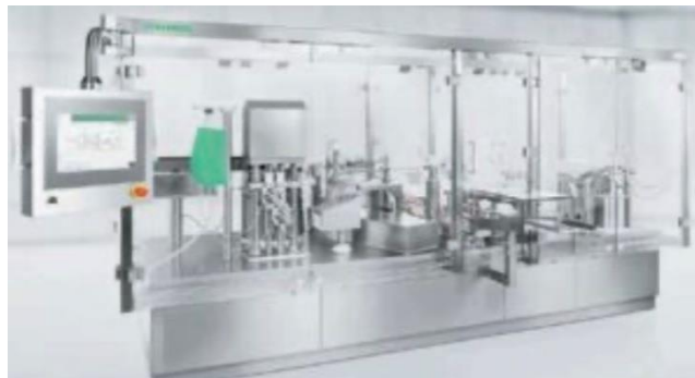
Рисунок 1.6 – Комбінована лінія для асептичного наповнення (комбіноване наповнення флаконів, картриджів та шприців).
