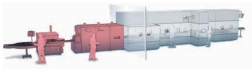
Рисунок 1.5 – Типова лінія для асептичного наповнення у флакони (мийна машина, стерилізаційний тунель, машина для наповнення, блок укупорювання пробками та блок закатки ковпачками).
