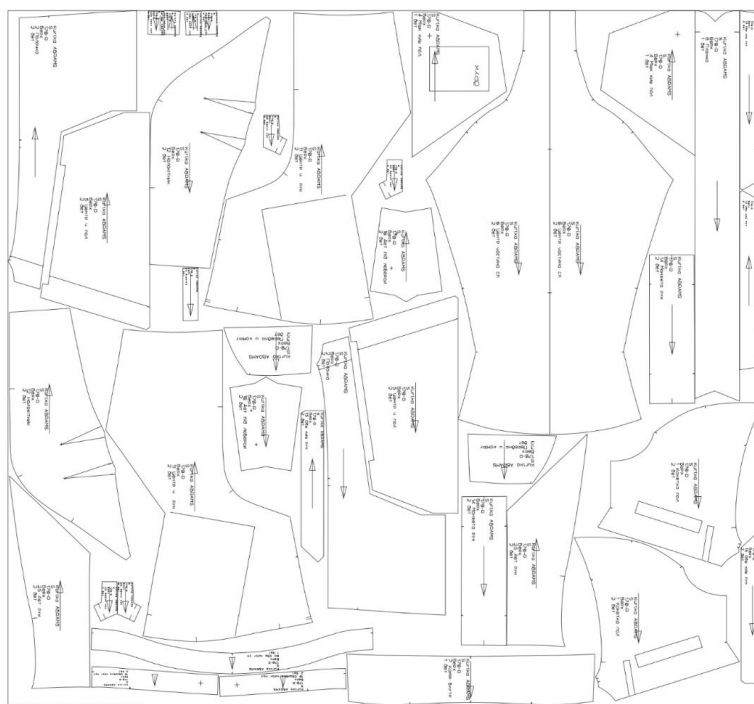
Рисунок 4.2.5 – Робоче вікно САПР Julivi – розкладка лекал верху захисної куртки для жінки військовослужбовця: Модель №1 «Level 4»
