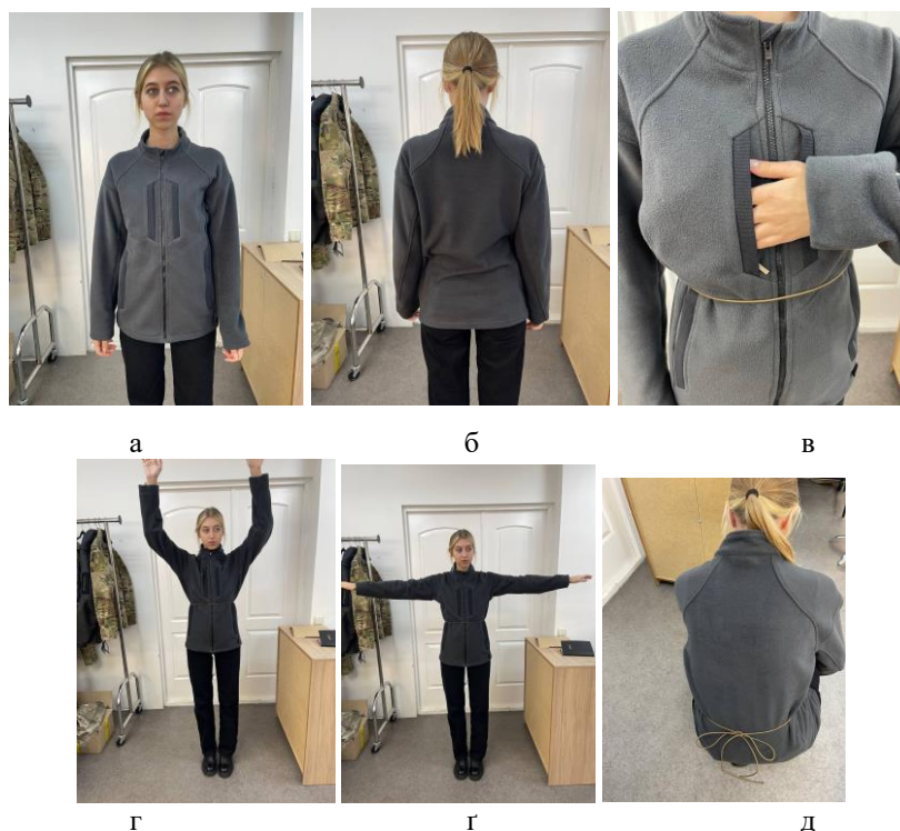
Рисунок 3.3.4 – Зображення захисної куртки Модель 3 при відтворенні користувачем відповідних рухів: а – Положення: руки вздовж тіла спереду; б – Положення: руки вздовж тіла ззаду; в – зображення зручності розташування кишень; г – Положення: руки догори; г – Положення: руки в сторони; д – Зображення спинки виробу у зігнутому положенні
