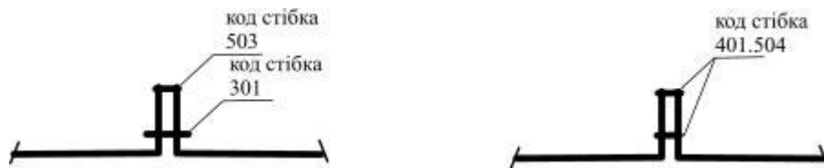
Рис.4.3 Умовне зображення обробки зшивання бокових швів верхньої частини сукні а) варіант 1, б) варіант 2
