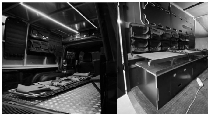
Рис. 2. Розміщення стаціонарних органайзерів в евакуаційному автомобілі
