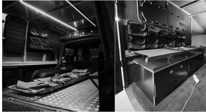
Рис. 2. Розміщення стаціонарних органайзерів в евакуаційному автомобілі
