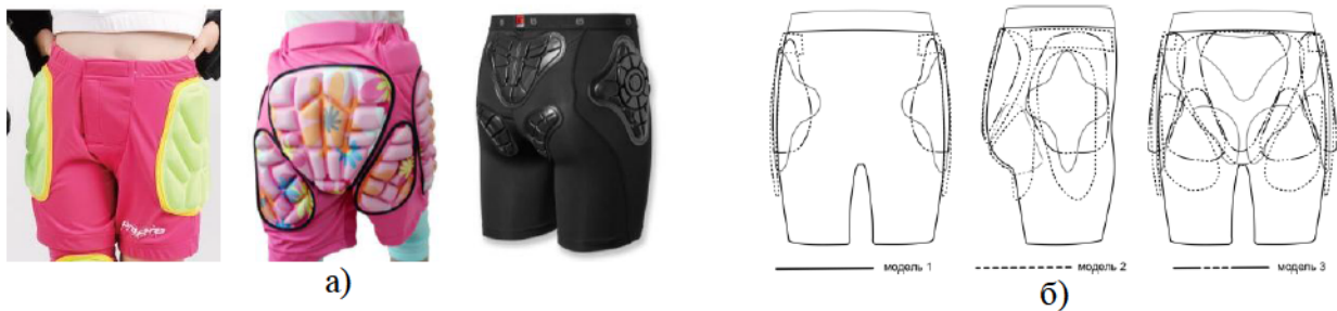
Рис. 1. а) зовнішній вигляд моделей захисних шортів; б) схематичне зображення найбільш поширених варіантів зонального розташування демпферних захисних прокладок на шортах
