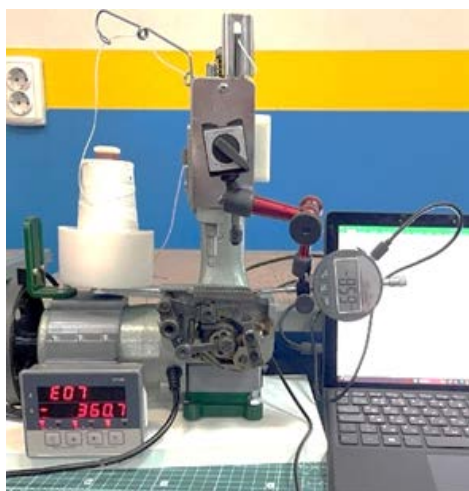
Рис. 3.8 Експериментальне дослідження функцій положення робочих органів: а) голки S(\varphi) , б) розширювача вздовж L(\varphi) та поперек Z(\varphi) строчки, в) рейки вздовж строчки T(\varphi) , 1 - експериментальні дні, 2 - апроксимовані дані
