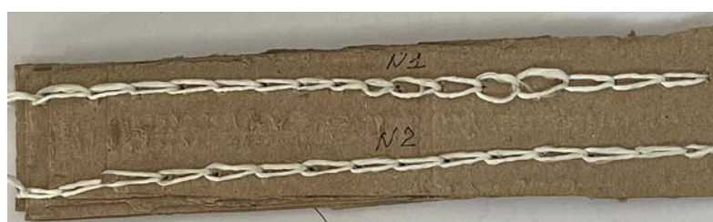
Рис. 4. 17 Зразок матеріалу з різною структурою шва: а) лицьова сторона; б) тильна сторона; 1 – зшивання на базовій конструкції механізму подачі нитки GK-9-2; 2 – зшивання на новій конструкції механізму подачі нитки
