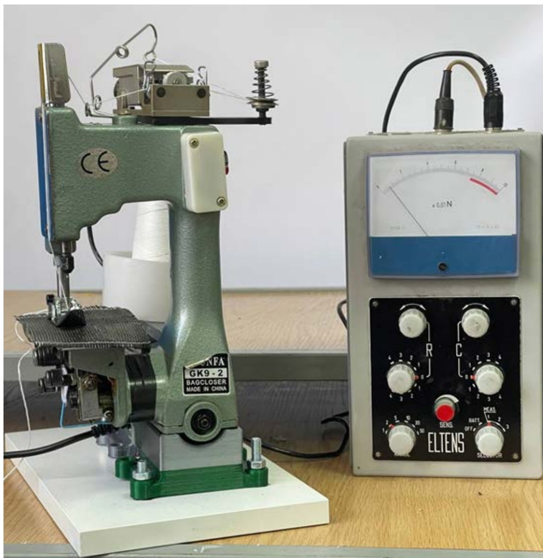
Рис. 3.11 Експериментальна установка: 1 - базова швейна машина GK-9, 2 - пристрій для вимірювання зусилля натягу, 3 - прилад вимірювання зусилля
