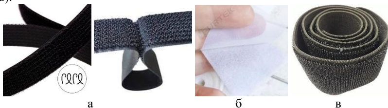
Рис.2. Різновиди текстильної застібки: а – гібридна; б – медична; в – еластична
