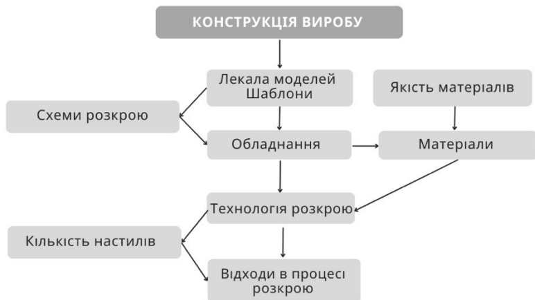
Рис. 1. Схема впливу матеріальних ресурсів на конструкцію виробу
