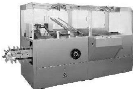
Рисунок 3.33. - Автоматична пакувальна машина Delta-100 для фасування в туби
