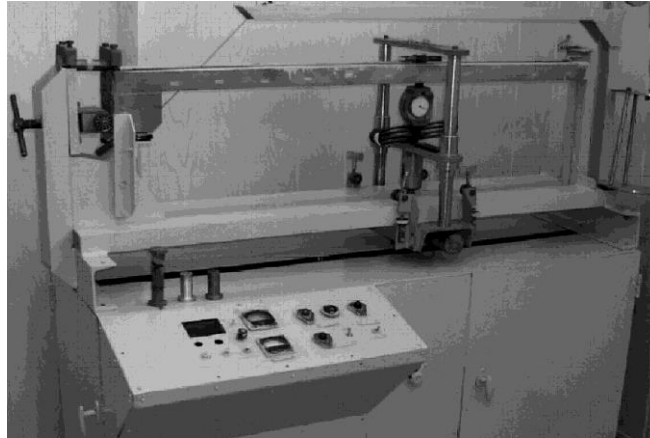
Рис. 1. Експериментальна установка для дослідження міцності клейових з'єднань при спільній дії нормальних та дотичних напружень
