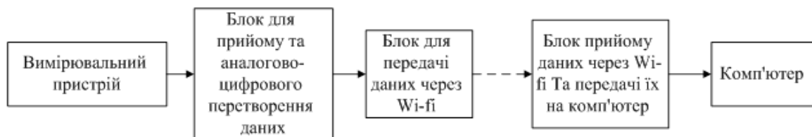
Рис. 1. Структурна схема пристрою
