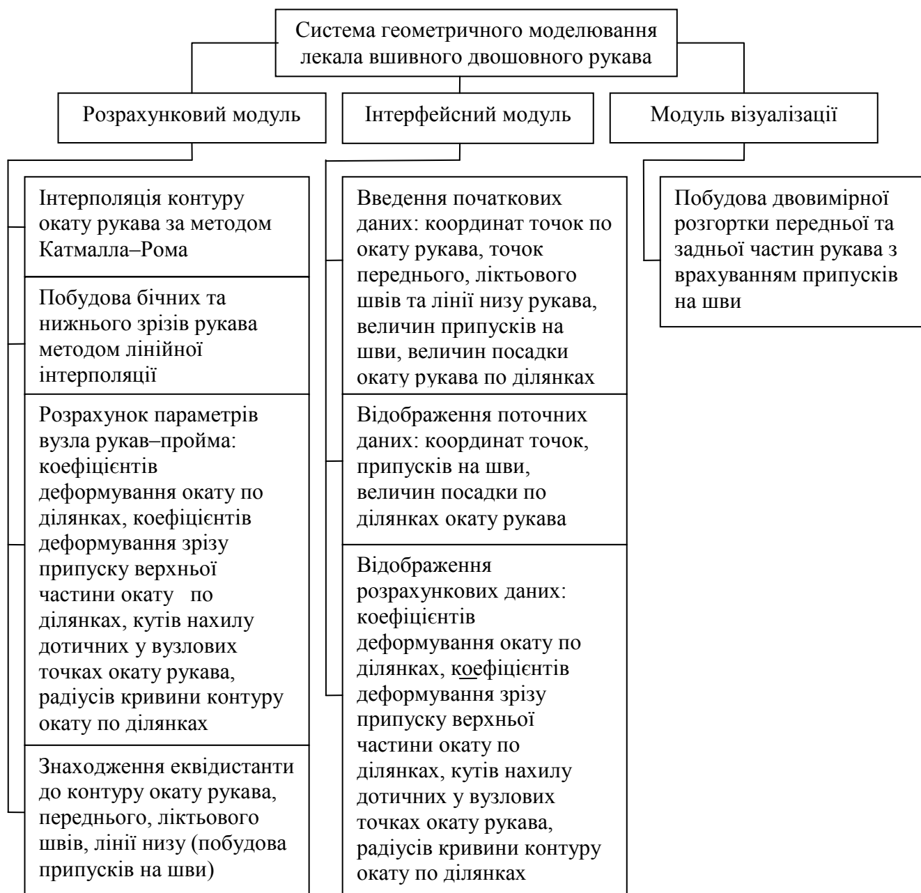
Рис. 4. Функціональна схема програмного комплексу «Геометричне моделювання лекала вшивного двошовного рукава»
