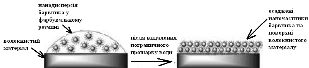
Рис. 1. Схема осадження наночастинок барвника на поверхню волокнистого матеріалу
