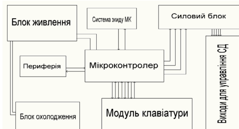
Рис.2 Блок схема системи управління освітленням
