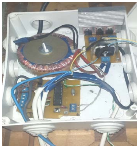
Рис.3 Виготовлена та змонтована система управління освітленням
