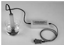
Рис. 12. Датчики вимірювання комплексу L-мікро: а – об'єму, б – оптичної густини, в – тиску, г – рН середовища
