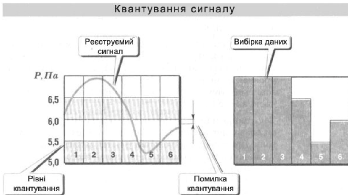
Рис. 9. Принцип квантування аналогового сигналу
