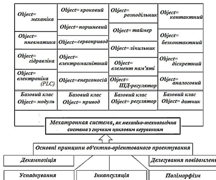
Рисунок 2 – Топологія об'єктно-орієнтованого конструктивно-технологічного проектування мехатронних систем
