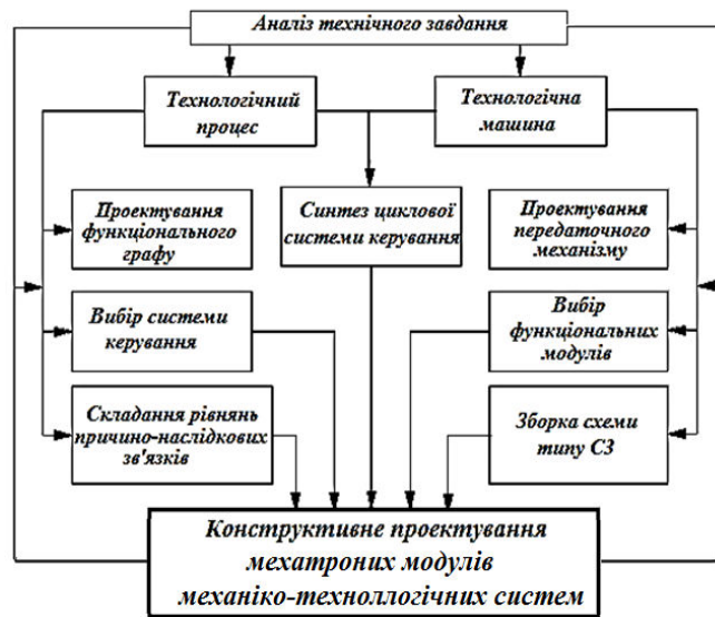
Рисунок 1 – Топологія традиційного конструктивного проектування мехатронних систем технологічних машин
