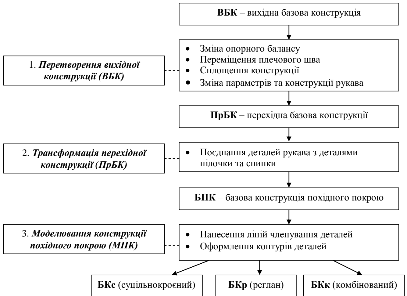
Рис. 2. Структурна схема процесу проектування конструкцій одягу похідних покроїв
